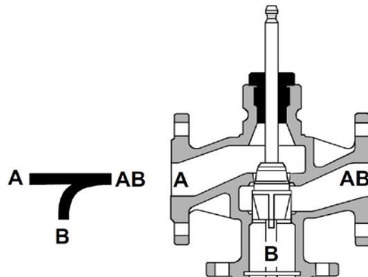
开有导向孔的阀塞直接与阀杆链接。
